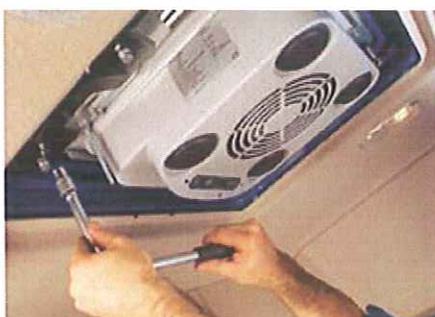
Conçu spécifiquement pour le véhicule : le CA 800 remplace le lanterneau
